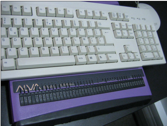
Plages braille utilisées avec un ordinateur dont elles vont reproduire l'affichage.
