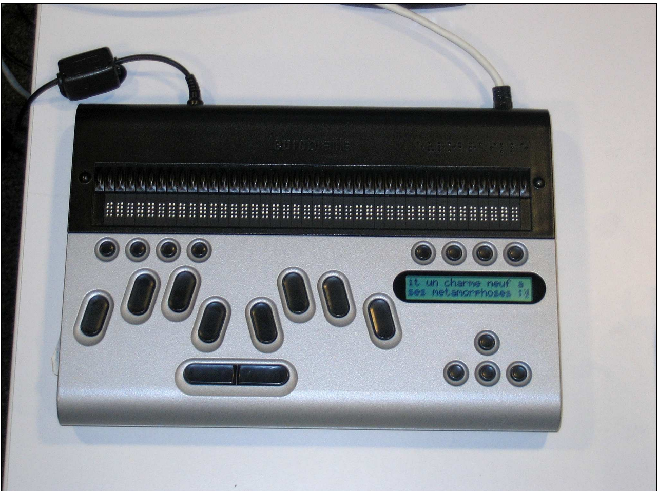
Exemple de technologie d'assistance: une plage braille munie d'un ordinateur embarqué, fonctionnant de manière autonome.
