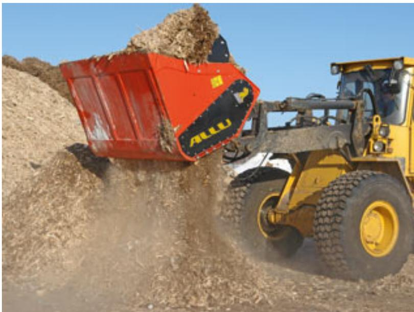
Figure 7 : Séparateur à pelle monté sur chargeur frontal (système ALLU)
