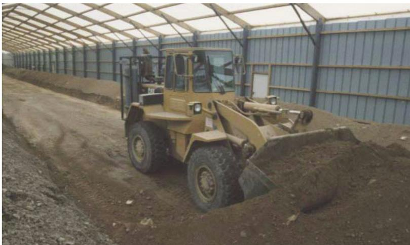
Figure 6 : Chargeur frontal ventilé ; nettoyage biologique du sol, Sindelfingen (D, Züblin Umwelttechnik GmbH)
