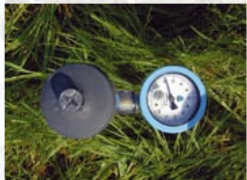
Les tensiomètres sont indispensables pour contrôler la portance du sol et les limites d'engagement.
