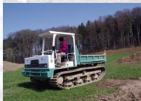
Le dumper léger sur chenilles peut circuler sur le sol en place.
