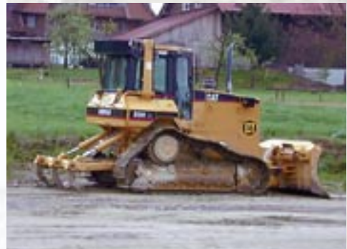
En principe, les bulldozers ne doivent être utilisés que sur l'horizon C.
