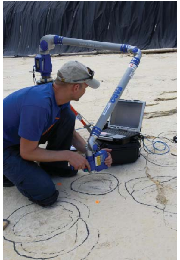
Balayage laser à résolution submillimétrique de traces de dinosaures à Courtedoux - Béchat Bovais (couche 500).
