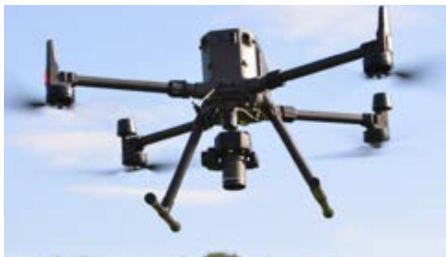
Drone avec caméra pour la cartographie des adventices ; source : Markus Sax, Agroscope
