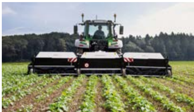
Exemple de traitement plante par plante assisté par caméra ; source : Ecorobotix
