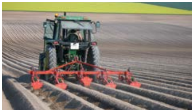
Mise en place de diguettes transversales ; source : Michel Martin, ARVALIS
