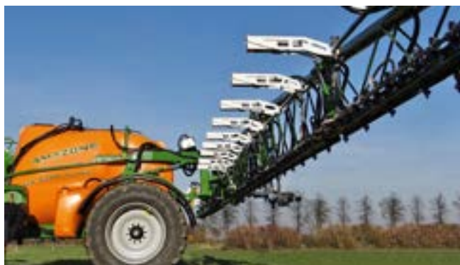
Système de caméra sur les rampes de pulvérisation conventionnelles ; source : AMAZONE
