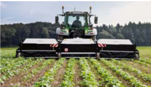
Exemple d'appareil pour le traitement plante par plante avec reconnaissance vidéo et protection complète ; source : Ecorobotix
