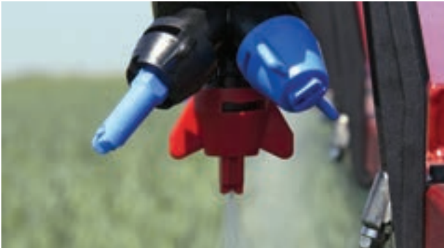
Porte-buses multiples pour un changement rapide des buses ; source : Joël Petermann, Alphatec
