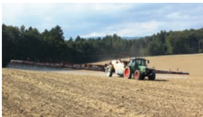
Pulvérisateur à rampe avec assistance d'air ; source : Joël Petermann, Alphatec
