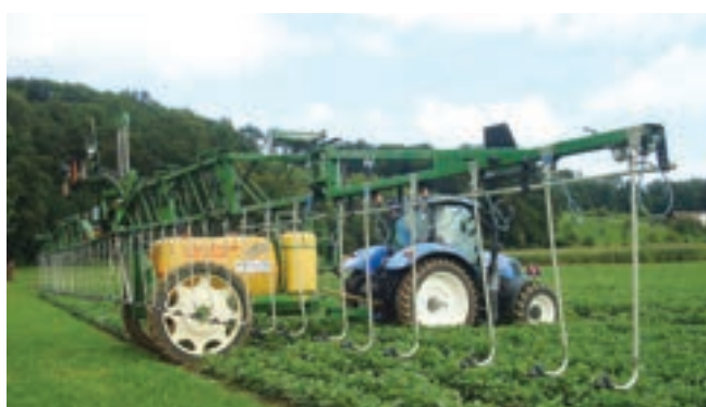
Technique d'injection sous-foliaire (Dropleg) ; source : Rolf Haller
