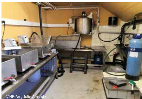
Figure 27 : Matériel permettant de réaliser la déchloruration des objets en alliages ferreux
