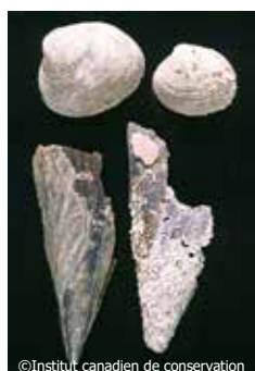
Figure 8 : Comparaison entre un coquillage exposé à des vapeurs d'acide acétique à forte concentration (à droite) et un autre non exposé
