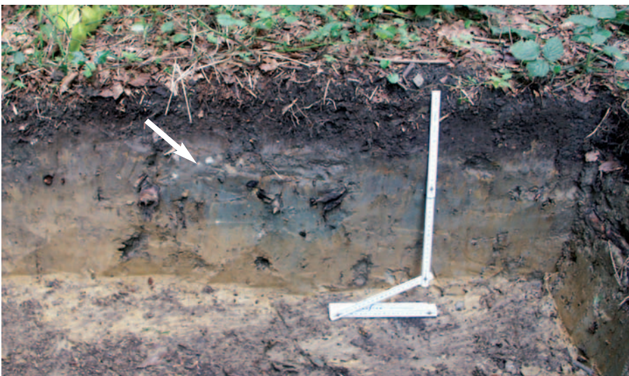
Fig. 4. Ornière avec caractéristiques d'hydromorphie. Les couleurs de réduction (gris-bleu) et les taches couleur rouille indiquent une aération limitée du sol. Le passage d'engins est à l'origine de la réduction du volume des pores et de l'interruption des connections entre eux.
