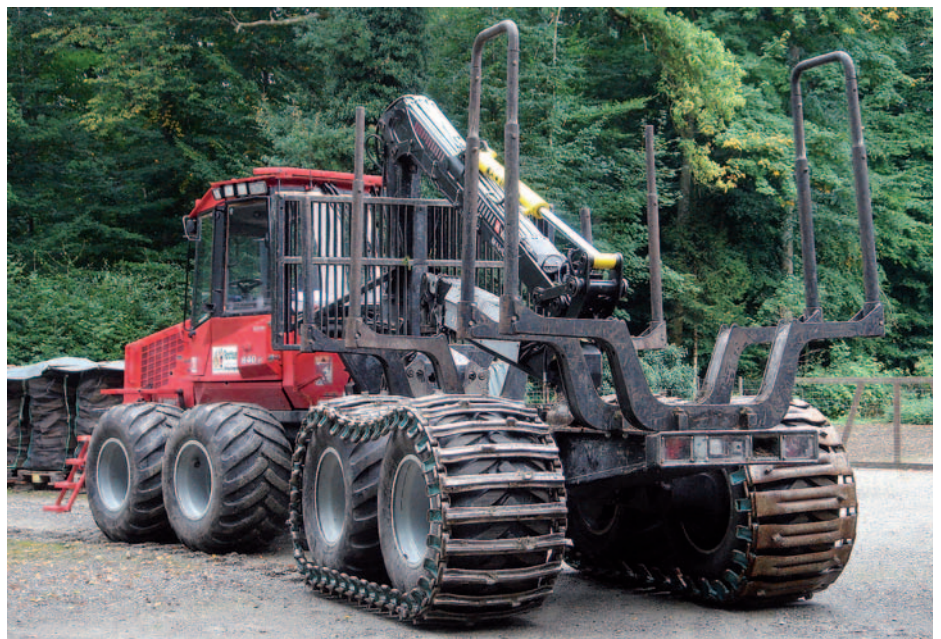
Fig. 13. Ce porteur forestier a été équipé, à des fins de démonstration, de deux types différents de semi-chenille Bogie: à gauche des semi-chenilles de traction destinées à améliorer les performances en montée et la sécurité en pente, à droite des semi-chenilles portantes permettant de préserver les sols à faible portance, sur terrains plats ou légèrement inclinés.
