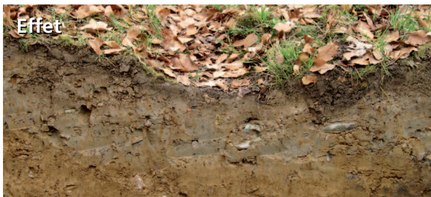
Fig 1. Le passage d'engins forestiers sur les sols en forêt cause des compactations et des déformations du sol. L'objectif de la protection physique des sols est de diminuer ces perturbations au moyen de différentes mesures.
