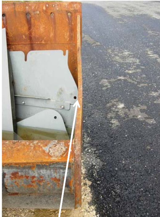
Abb. 3: Durch die Explosion verursachte, sichtbare Deformation der Baggerschaufel
