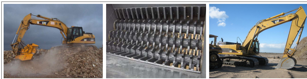
Figure 4: (a) Pelleteuse équipée d'un godet concasseur. (b) Godet broyeur. (c) Pelle mécanique avec bras à longue portée (sur cette image, portée maximale 19.6 m).
