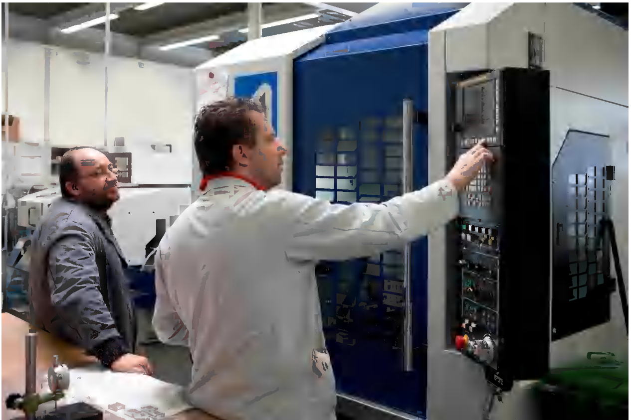
Appel d'un programme sur un centre d'usinage à cinq axes numériques.
