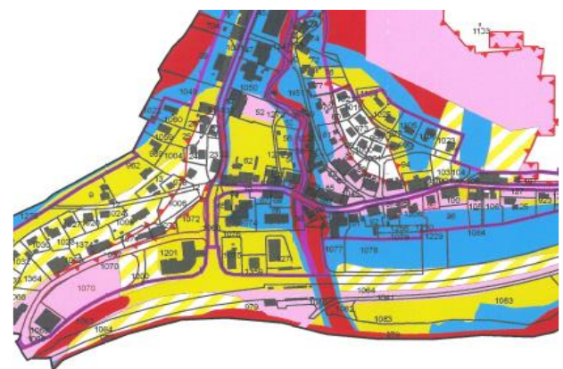
Représentation des dangers naturels dans le plan des dangers naturels (triangles rouges = périmètre PDN; surface rouge = secteur de danger élevé, surface bleue = secteur de danger moyen, surface jaune = secteur de danger faible, surface rose = secteur d'indication de dangers, en blanc = aucun danger connu)
