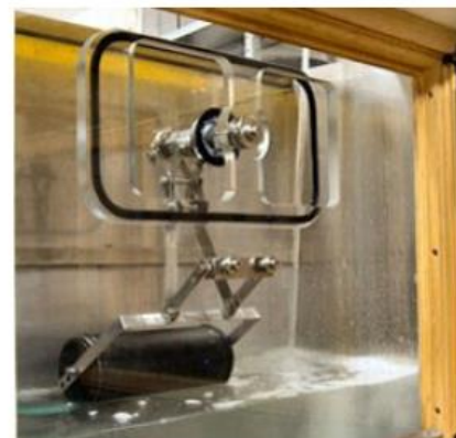
Image: fenêtre de protection contre les crues en verre acrylique (fermeture automatique avec flotteur) (source: Neo Vac S.A.)
