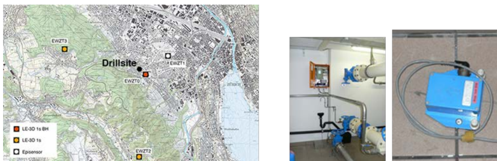
Figure 29 : Réseau de monitoring sismique du projet Triemli à Zurich (gauche) et photos des sismomètres installés (droite) (source : service sismologique suisse)
