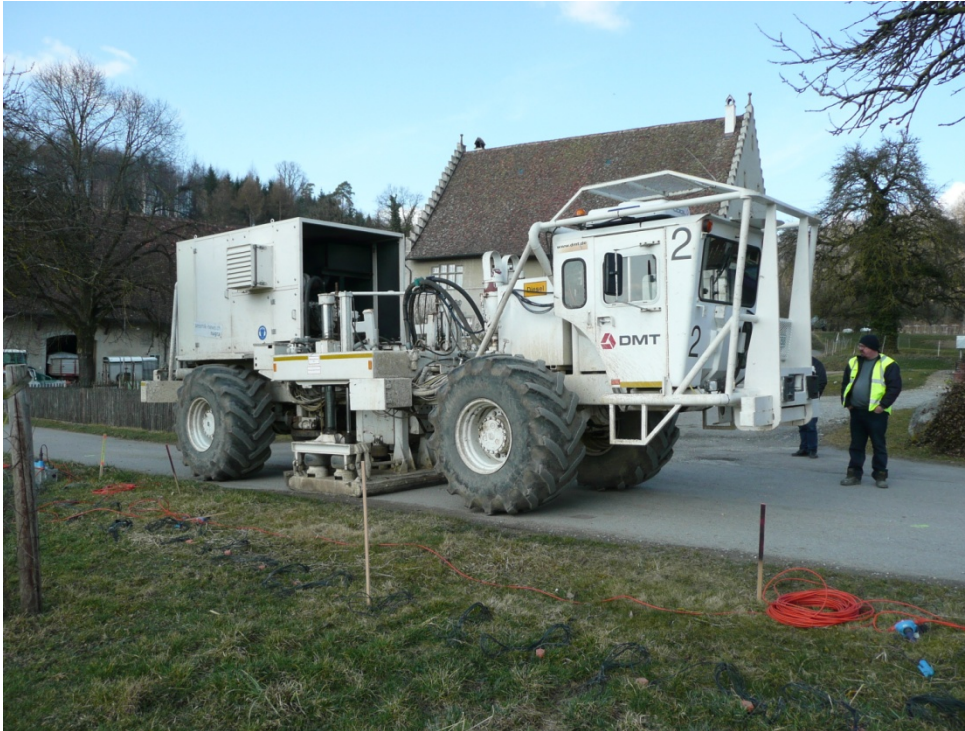
Figure 12 : Camion vibreur (émetteur) et géophones (récepteurs) durant une campagne de sismique-réflexion. Schaffhouse, mars 2012 (Photo O. Zingg)
