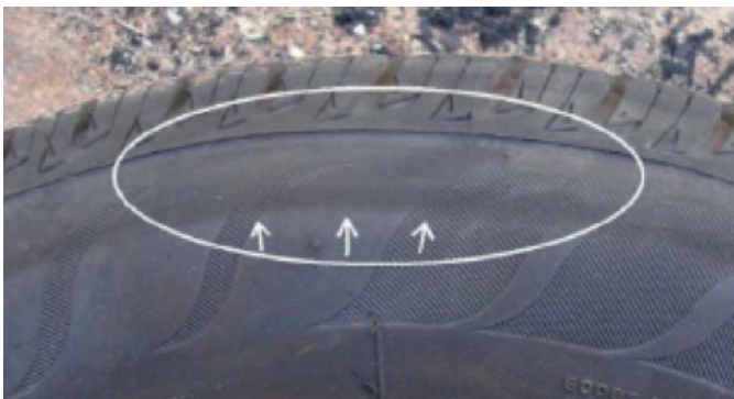
Pneu ayant roulé à plat. Souvent accompagné d'une teinte bleutée.
