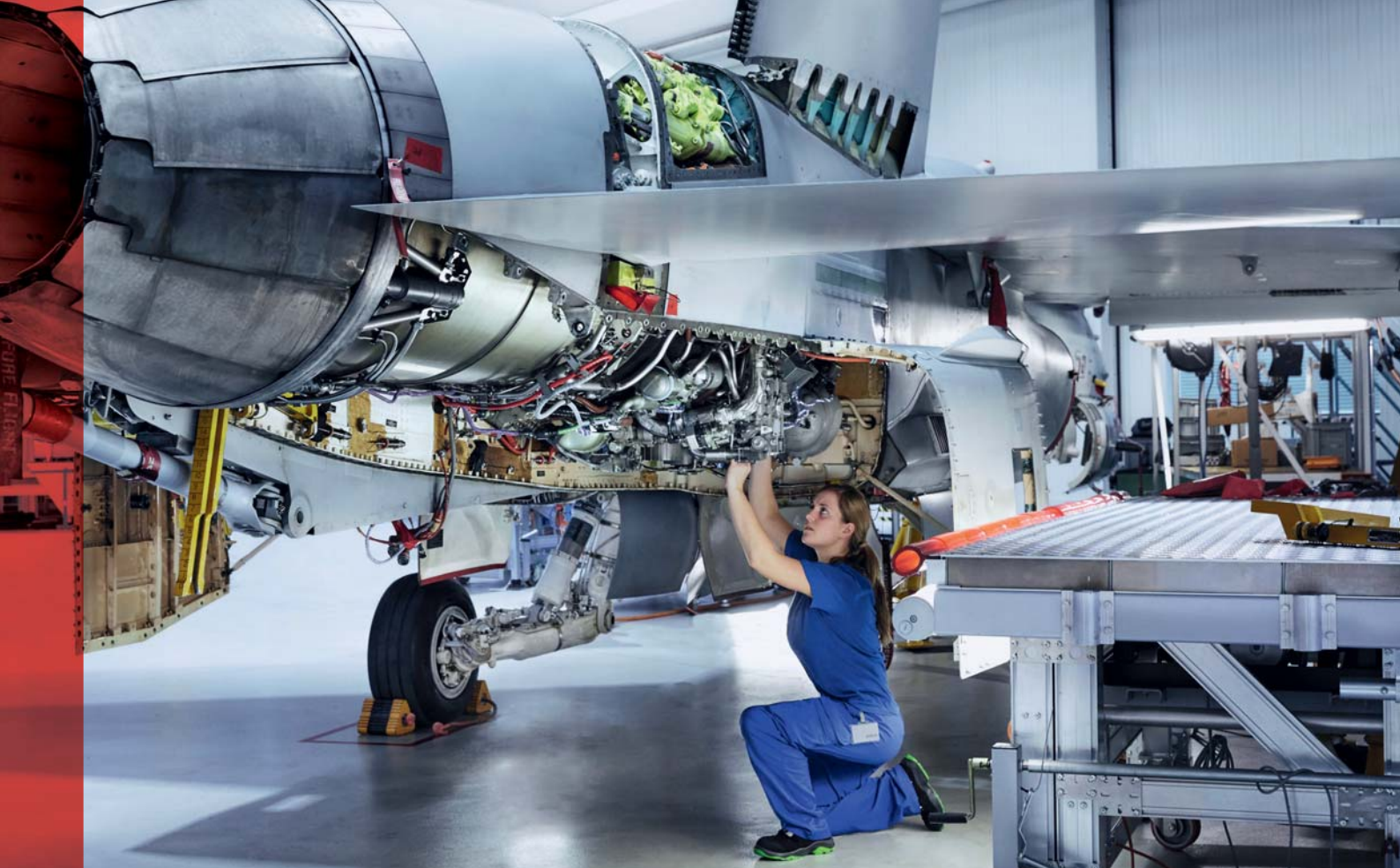
La maintenance d'un avion de combat F/A-18, dans les ateliers de RUAG Aviation ; l'une des nombreuses tâches de l'entreprise lucernoise.
