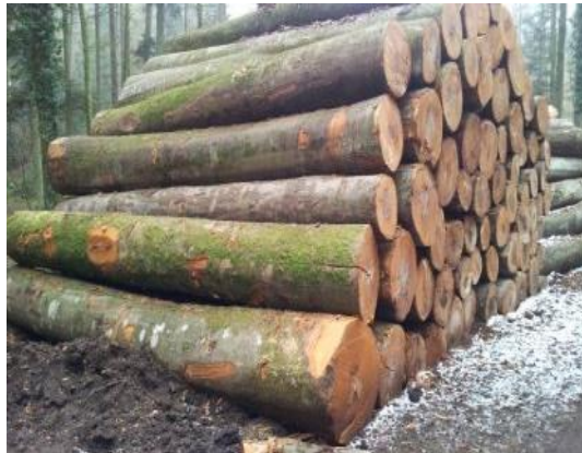
Fissures et torsions dues aux tensions internes
