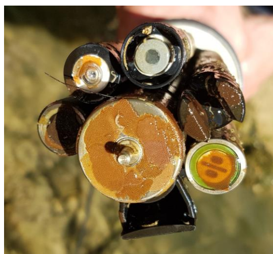
Figure 30 Pontes d'hétéroptères aquatiques perturbant le fonctionnement de la sonde EXO.
