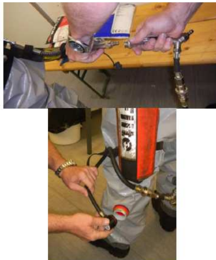
3. Ankoppeln des Y-Stückes und des Belüftungsequipments an die Hinterlüftung
