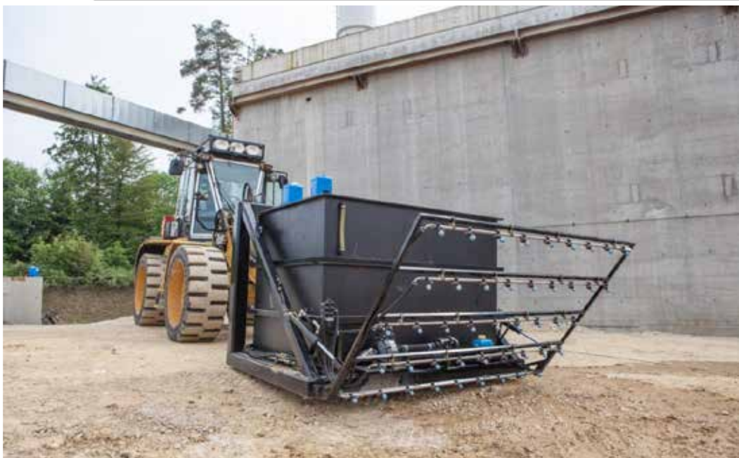
Dispositif d'aspersion de surface de l'encaissant argileux
