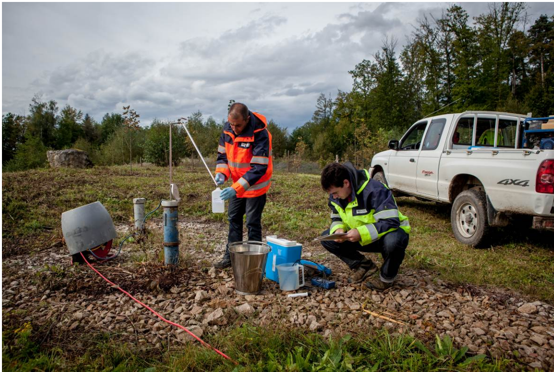
Septembre 2012 : des collaborateurs du bureau CSD prélèvent des échantillons d'eau souterraine sur un piézomètre à l'extérieur du site de la DIB lors de la « grande campagne ».
