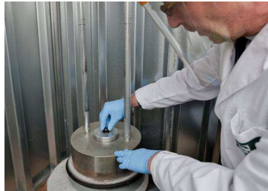
Analyses complémentaires: test rapide chimique dans le laboratoire et test du marteau (test physique sur la sensibilité aux chocs et aux frottements).
