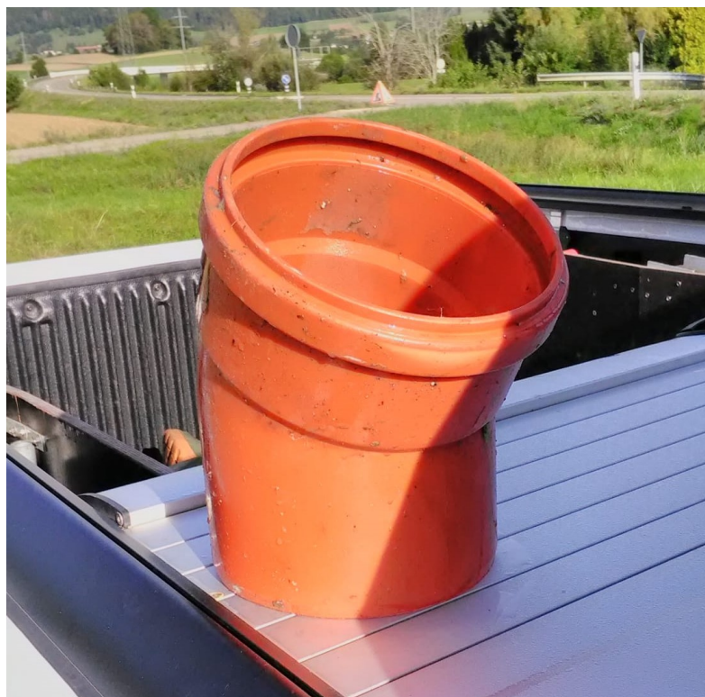
Figure 3 Un élément de tuyau en PVC parvenu par accident dans la canalisation a bouché le bassin d'eaux pluviales situé en bordure du Tabeillon et provoqué un déversement massif d'eaux usées dans le ruisseau.
