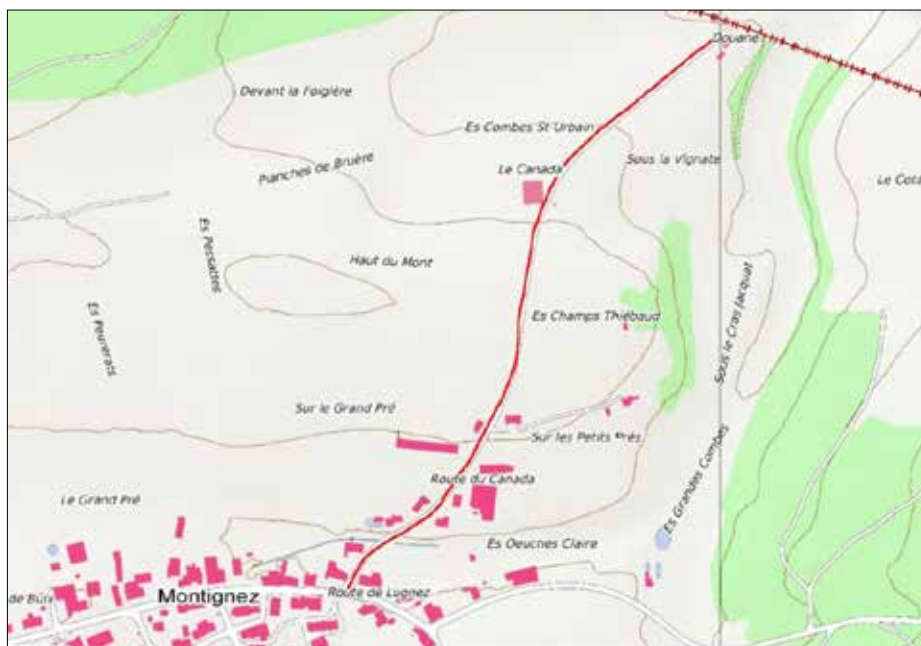
Fig. 2.134 Montignez – Route du Canada. Plan de situation de la conduite le long de la route du Canada (en rouge). Extrait de la carte nationale tirée du GéoPortail jura.ch
