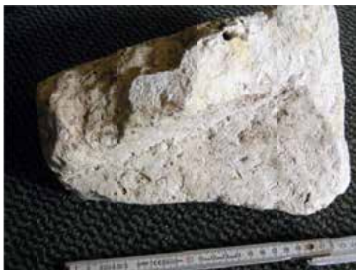
Abb. 7: Architekturelement aus kreidigem Korallenkalk.
