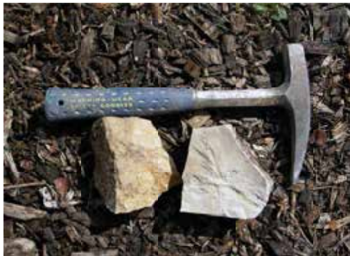
Abb. 5: Links: Oolithischer Rauracien-Kalkstein; Rechts: Feinkörniger, muschelig brechender Rauracien-Kalkstein.
