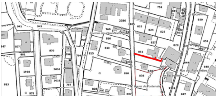
Fig. 2.202 Porrentruy – Annonciades, Capucins, Route de Fontenais. Plan de situation d'une tranchée de raccordement privé au thermoréseau, à la route de Fontenais (en rouge). Extrait de cadastre tiré du GéoPortail
