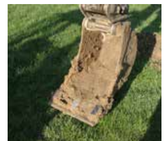
Fig. 2.38 (à gauche) Bonfol – Cras Chalet. Godet à dents large de 40cm modifié avec une plaque en acier pour en faire un godet lisse. Photo P.-A. Borgeaud, OCC-SAP
