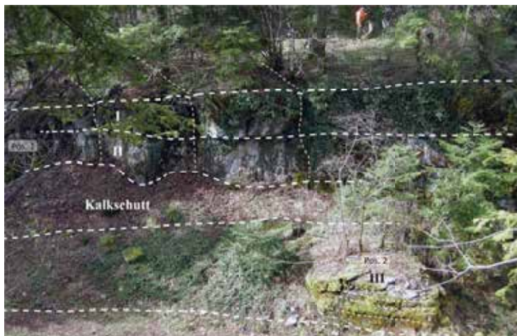
Abb. 2: Westliche Flanke des Halsgrabens (Steinbruch; Pos. 2 und 23). Aus geologischer Perspektive können drei Fazies (I bis III) differenziert werden, die sich bezüglich ihrer Ausprägung respektive der Bankung voneinander unterscheiden. Braun eingezeichnet sind die vertikalen Klüfte.
