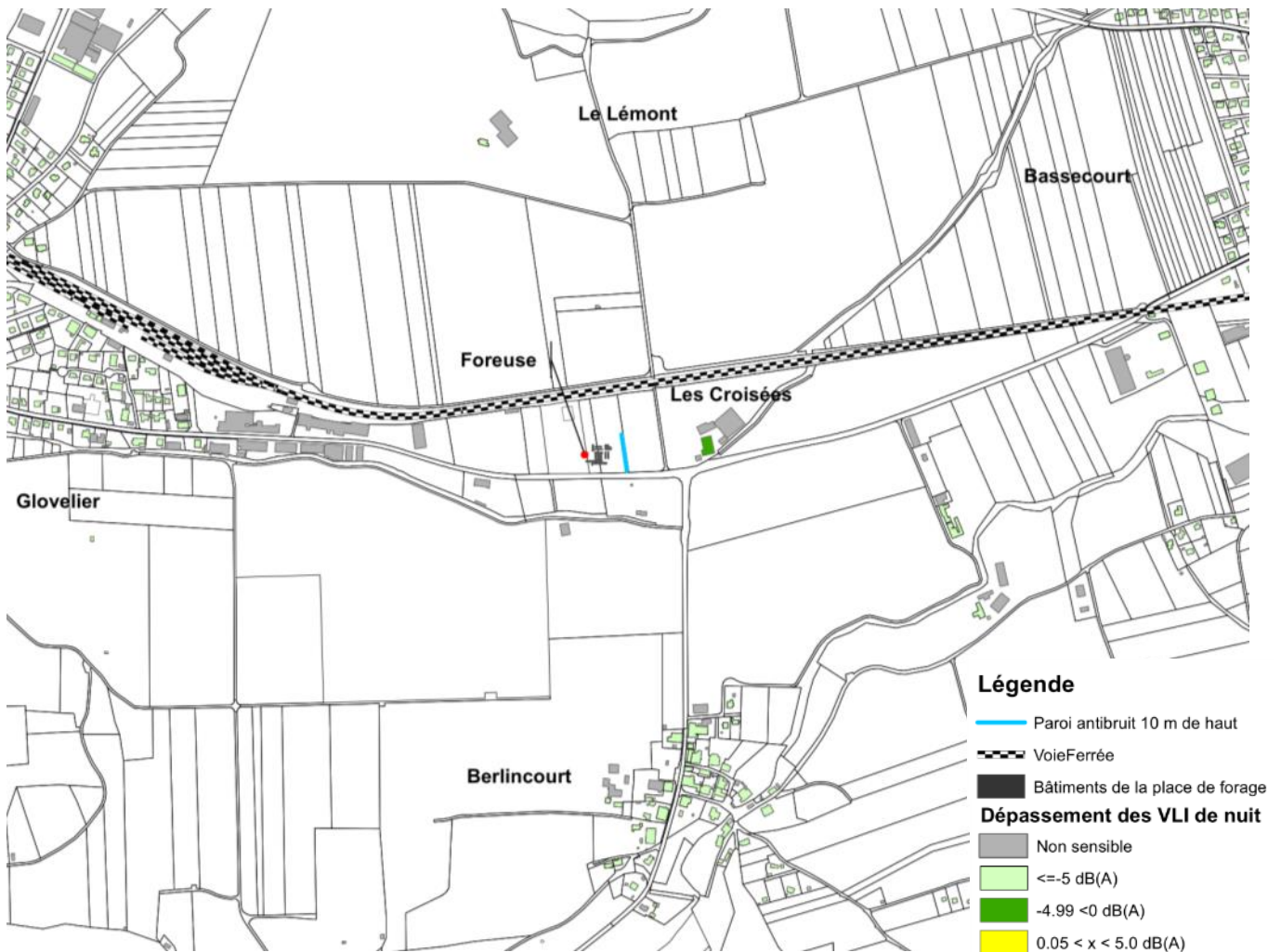
Figure 6-1 : Illustration des résultats pour la variante F3.2, foreuse hydraulique avec paroi antibruit de 10 m de haut, scénario A (Source : CSD)
