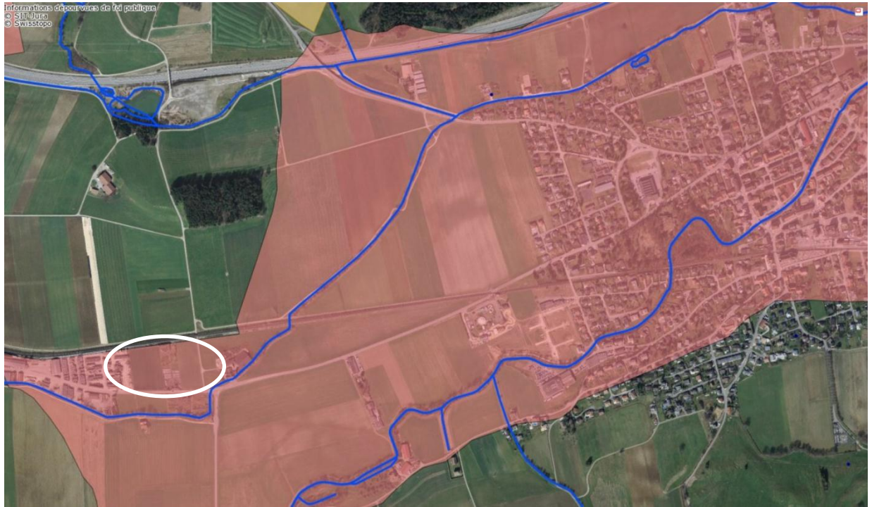
Figure 7 : secteurs de protection des eaux pour le site et en aval hydraulique. La zone en rouge indique les secteurs Au. Il n'y a pas de secteurs S1, S2 ou S3 en aval direct du site. Le site est entouré en blanc. Source : géoportail cantonal.
