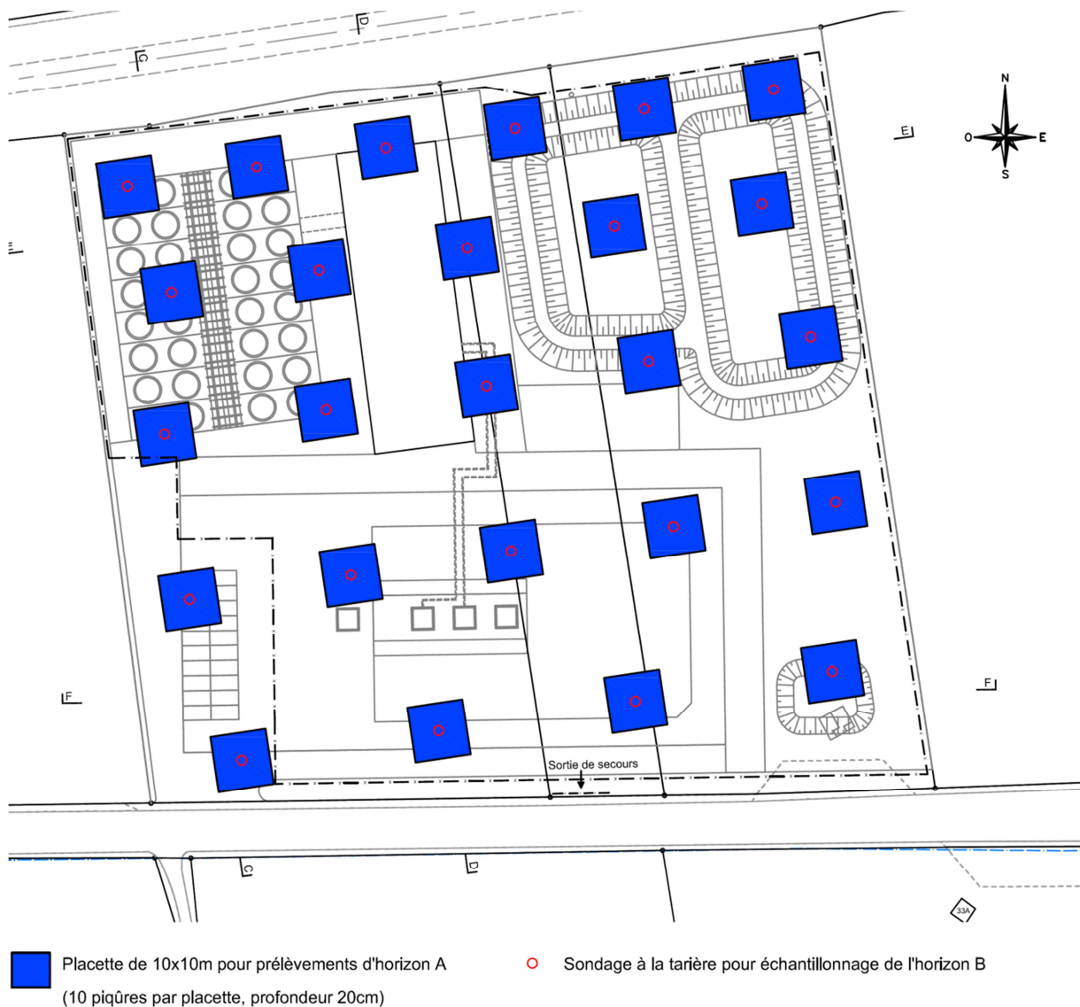
Figure 29 Localisation des placettes et sondages pédologiques permettant de définir l'état de pollution du sol
